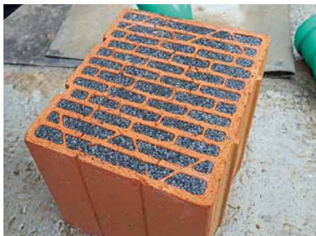
Hochdämmende, monolithische Ziegelsteine aus einem Ziegelwerk in Wöllstein sollen helfen, Heiz- und Kühlkosten für das zukünftige Hospiz zu reduzieren.
